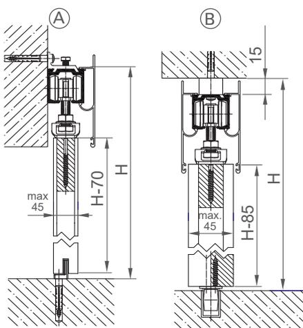
A - Schiene befestigt an der Wand mit Winkel bis 45 mm Türstärke
